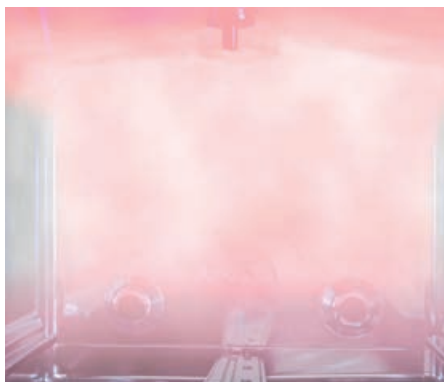
... pour un refroidissement plus rapide. La vapeur se condense sur la paroi intérieure froide...
